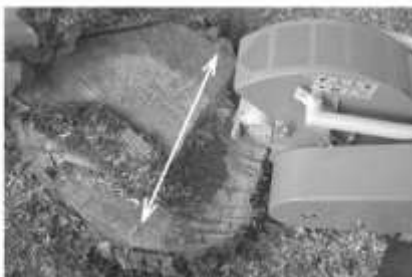
Fresare in moto oscillante per strati successivi
